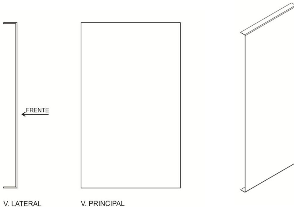
Podrá ser de chapa de acero o de acrílico, para la fijación del mensaje publicitario mediante ploteo de corte, de impresión u otros medios, o cualquier otro material que admita el tratamiento descrito.
